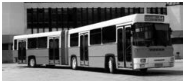
Článkový autobus Čavdar 141 o délce 17 700 mm se v Bulharsku vyráběl na základě rakouské licenční dohody. První prototyp, který vznikl podle rakouského autobusu Steyr SG18 HUA 280, se objevil v roce 1988. Stejný rok byl firmou Steyr představen i první prototyp této typové řady v Rakousku, kde začal být vyráběn od roku 1990. Vzhledem k politickým změnám v Bulharsku, ale i v celém východním bloku, se sériová výroba autobusů Čavdar 141 naplno rozeběhla až v roce 1993
