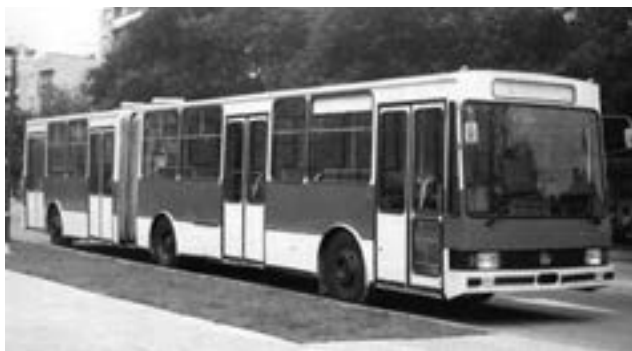
Článekový Čavdar B 14-20 z roku 1982 měl stejnou motorovou skupinou jako standardní typ B 13-20. Autobus o délce 16 780 mm nabízel 38 míst k sezení a 109 k stání, byl v provozu ve všech větších bulharských městech
