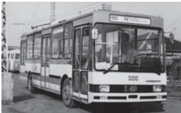
Začátkem osmdesátých let se i Bulhaři pokusili o vlastní výrobu trolejbusů. A tak byl roku 1982 vyroben prototyp standardního trolejbusu Čavdar T 13-30, postavený na bázi autobusu B 13-20
