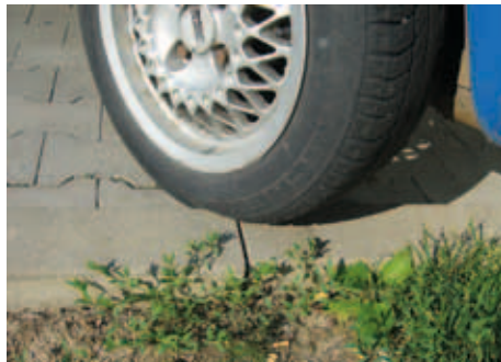
Riziko poškození pláště: špatné parkování na obrubníku
