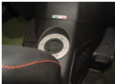
Snadno přístupné, uzamykatelné víčko nádrže je umístěno na krytu středové části rámu, mezi podlázkami
