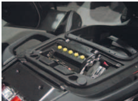
Akumulátorová baterie pod zadní částí sedadla je přístupná po odklopení sedačky
