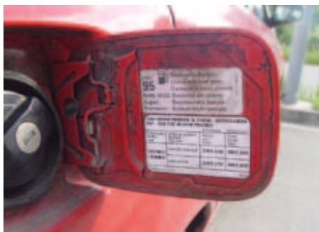
Štítek s předepsanými hodnotami pro nahuštění pneumatik
