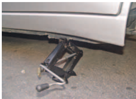
Zvedák založte na místo doporučené výrobcem vozidla
