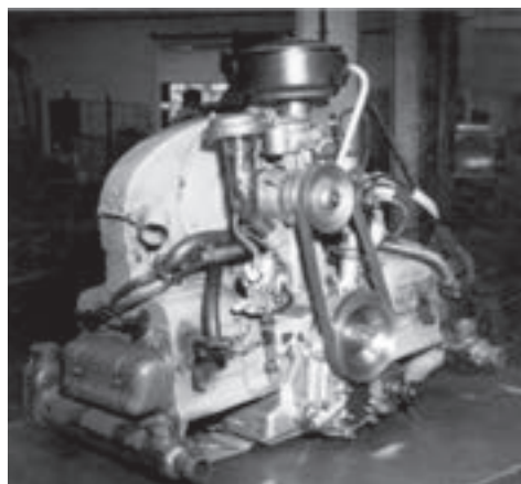
Původní verze motoru Š 977 osazená jedním karburátorem
