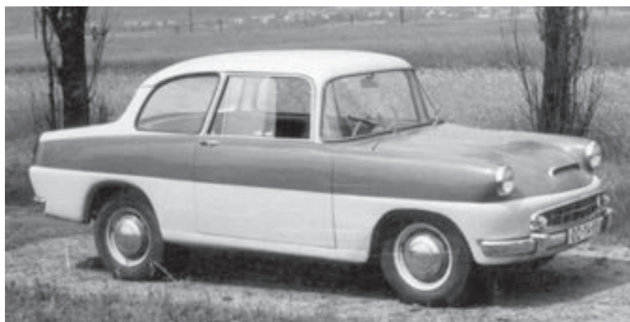
Prototyp Š 976 s předním pohonem měl ve dveřích posuvná okna
