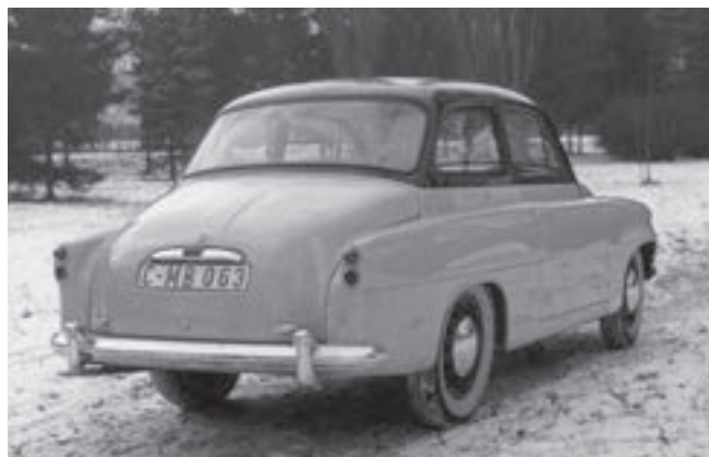
Prototyp Spartak měl páteřový rám a dřevěnou kostru karoserie
