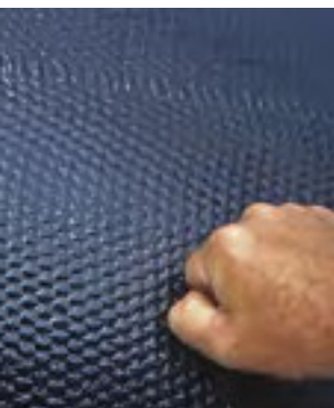
Obr. 3.3 Stabilitu plastového bazénku poznáme již na dotek. Obvyčejné polypropylénové nebo polyetylenové vany se působením tlaku více deformují
