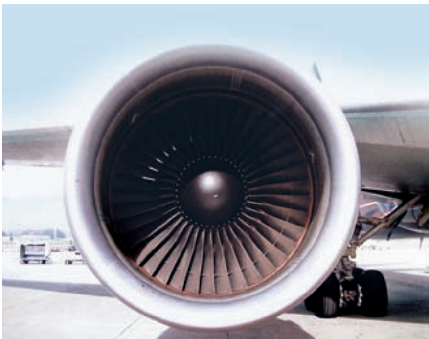
Dmychadlo vytváří větší část celkového tahu motoru.
