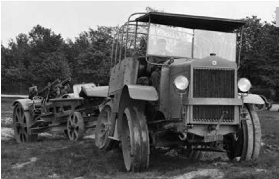
Plzeňská verze TAR 4 pro Jugoslávii při zkouškách, již tedy je to Škoda TAR 4. Je zřetelně vidět řízení všech kol
