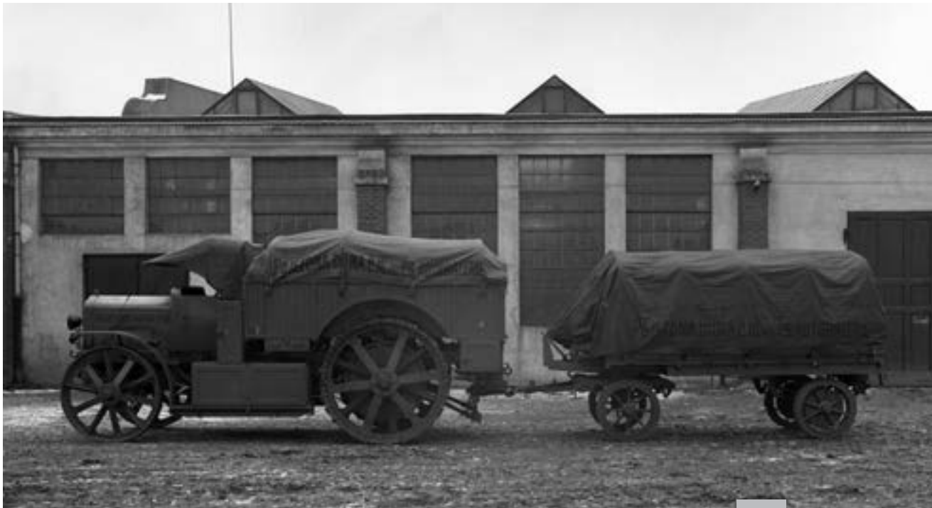
Pojízdná dílna československých autobaterií. Na nádvoří plzeňské Škodovky stojí jedna z dokončených dílén na podvozku typu „U“ s přívěsem
