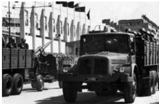
▼ Tatra 111 N (naviják), vozidlo upravené podle specifických požadavků armády z roku 1951 a vyráběné od roku 1952. Vojenská přehlídka 9. května 1955, Praha, Letná [1]
