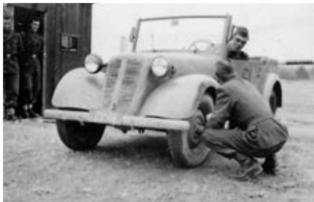
▼ Tatra 57K vyráběná pro československou armádu v letech 1945–1949. Vozidlo nebylo vybaveno předním zastíracím světlometem Notek
