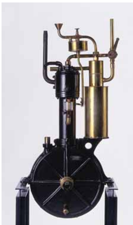
„Stojací hodiny“ (1884): Čtyřdobý benzinový jednoválec Daimler, 264 cm 3 / 1 k, 60 kg A “Grandfather Clock” (1884): The four-stroke petrol engine by Daimler, 264 cc / 1 hp, 60 kg
