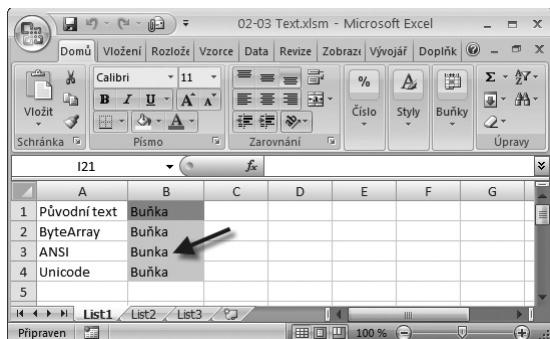
Obrazek 1.24: Výsledek různých procedur, které přečtou a zpětně zapíší řetězec na list
