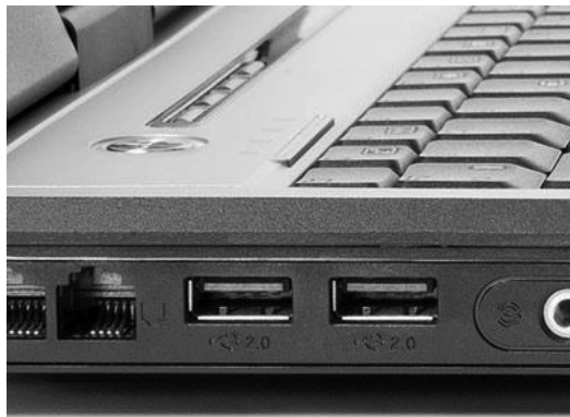
Obrázek 1.10: Pohled na USB konektory, ke kterým můžeme připojit rozličná zařízení
