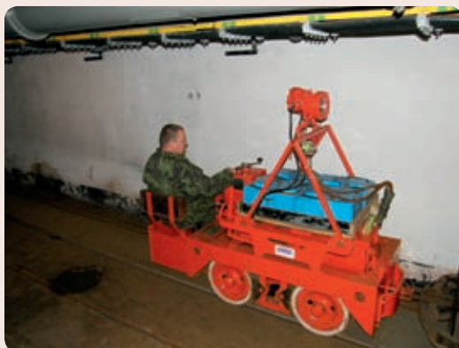
Úzkorozchodná drážka v podzemí tvrze počítala původně pouze s ručním tlačím vozíků. Využití lokomotivního pohonu pochází z doby využívání tvrze jako armádního skladiště.
