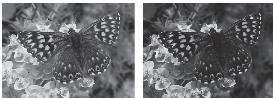
Obrázek 1.20 Nárůst tiskového bodu způsobuje nežádoucí ztmavnutí obrázku. Obrázek vpravo znázorňuje, jak by vypadal výsledek tisku na nenatíraný papír, kdybychom v předtiskové přípravě nárůst tiskového bodu nekompenzovali.
