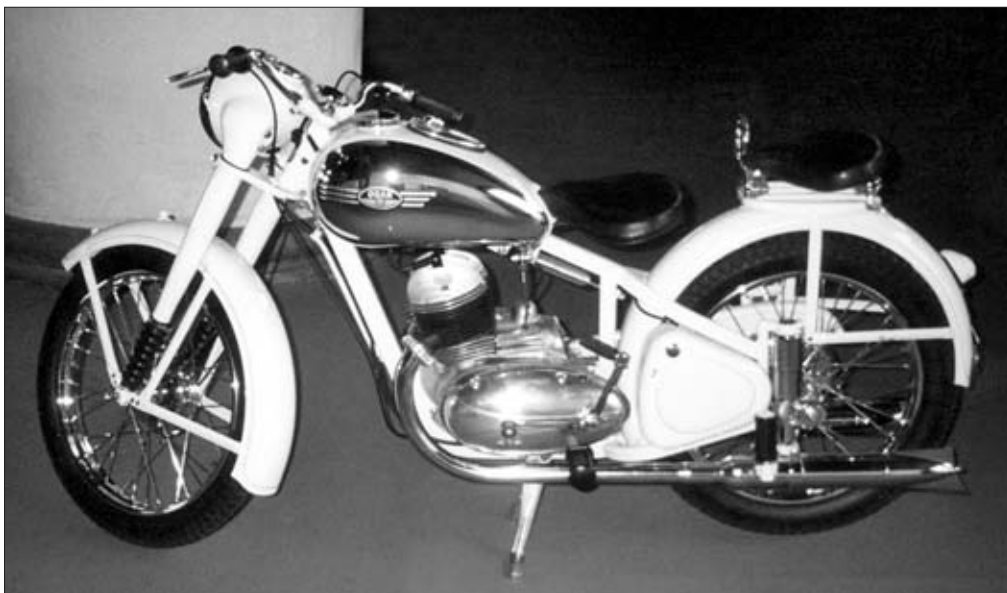
Výstavní bílý „pérák“ po půl století jako exponát výstavy Retro Prague pořádané v r. 2002. Kovová spínací skříňka prozrazuje, že se jedná o starší provedení typ 10 vyráběné v letech 1946–1950
