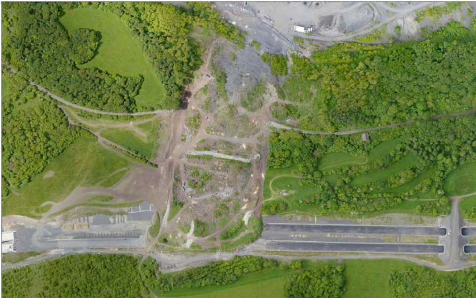
Obrázek 5.10 Letecká ortofotomapa sesuvu na dálnici D8 pořízená mapováním prostoru dronem
