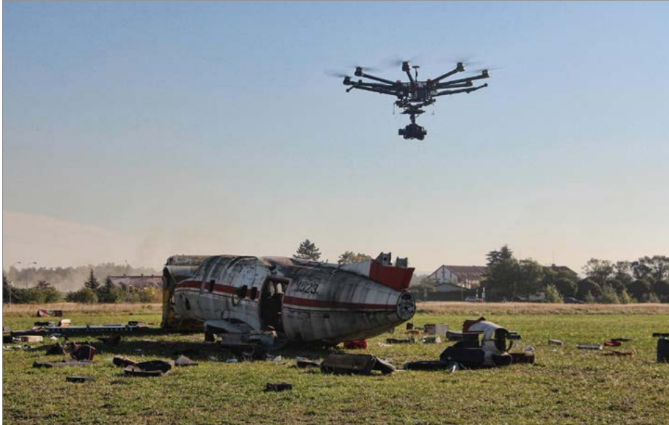
Obrázek 5.8 Využití dronu pro letecký monitoring místa letecké nehody a podpora pro velitele zásahu při dalším rozhodování v reálném čase
