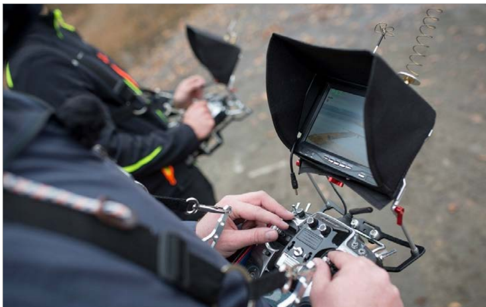
Obrázek 5.4 Pilot a operátor, každý se svým dálkovým ovládním, včetně monitoru pro řízení natáčení v reálném čase z kamery pro operátora a monitoru pro pilota, který v něm může sledovat pohled z kamery na přední straně dronu
