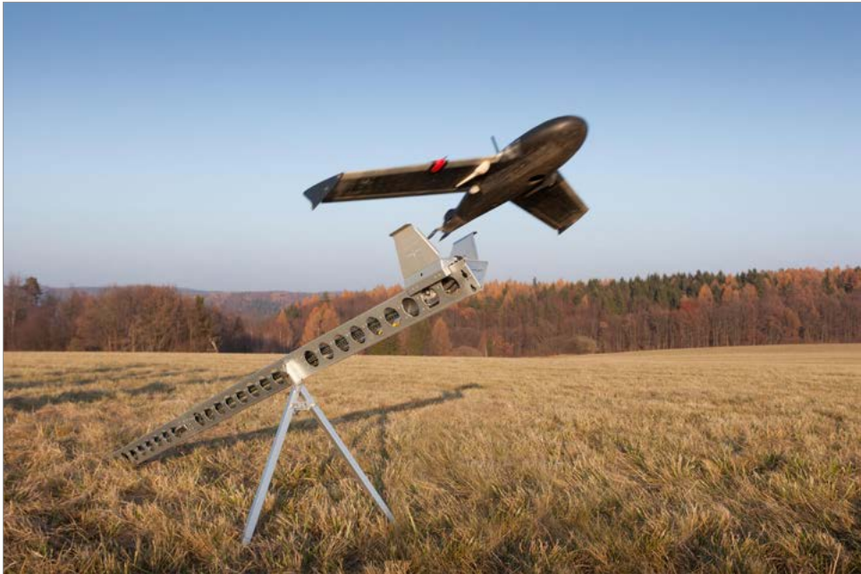
Obrázek 3.9 Vzlet křídlového dronu z odpalovací rampy stiskem vzdáleného ovládání
