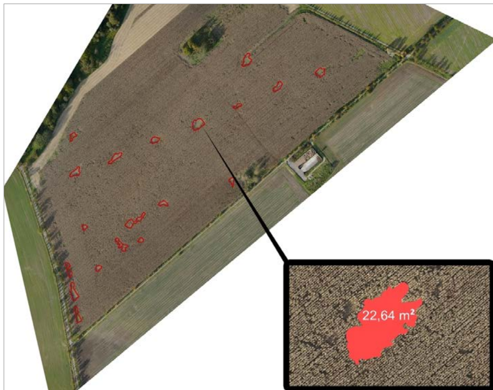
Obrázek 5.11 Letecká ortofotomapa pole s kukuřicí pořízená mapováním dronu ihned po zjištění prostoru poškozeného působením divokých prasat a výsledné zaznamenání celkových ploch poškození pro případné vymáhání škod zemědělcem
