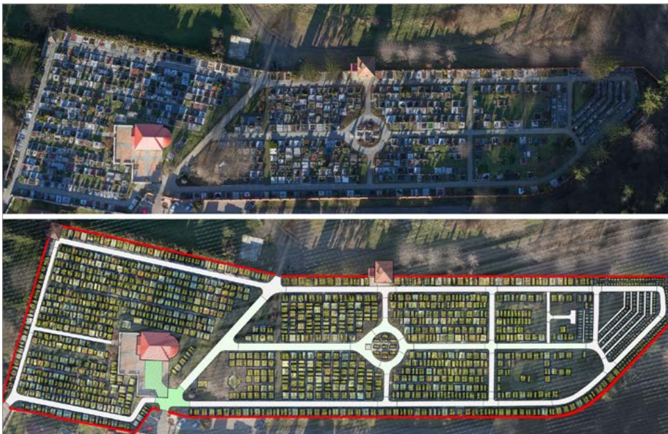
Obrázek 5.12 Nahoře letecká ortofotomapa hřbitova pořízená mapováním dronu a dole vyhodnocená digitální mapa z tohoto mapování s přiřazenou databází tvořící celý geoinformační systém hřbitova
