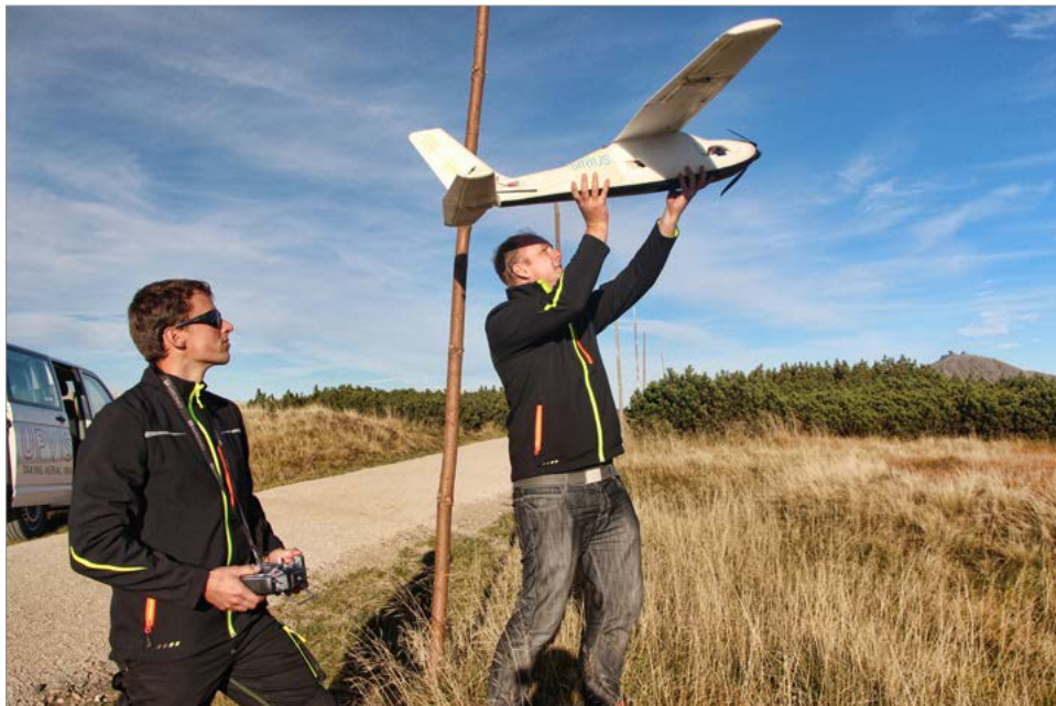
Obrázek 3.10 Bezpilotní mapovací letoun MaVinci Sirius při vzletu hodem z ruky
