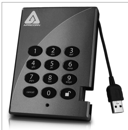
Obrázek 1.1: Autentizace přístupu k údajům na disku pomocí kódu
