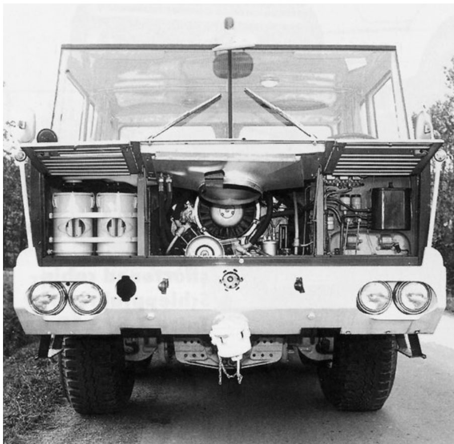
Čelní pohled na tahač T-813 TP 6 × 6: přední kryty masky zvednuty, pod levým dva čističe vzduchu VTC 500, na středním krytu pod plechovým krytem usměrňujícím vzduch k ventilátoru motoru je připevněn chladič oleje, pod pravým vlevo vyrovnávací nádržka kapalinového ovládání spojky, dvě vyrovnávací nádržky kapalinového ovládání brzdíče, vpravo nádržka na kapalinu strojního řízení
