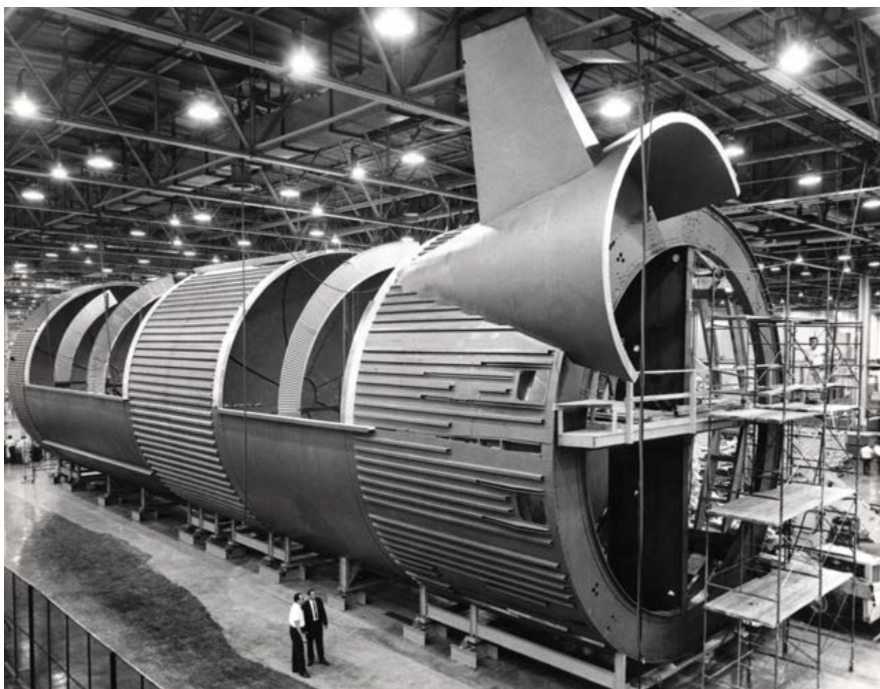
V dílnách firmy Boeing vznikla nejprve rozměrová maketa prvního stupně S-IC rakety Saturn V.
