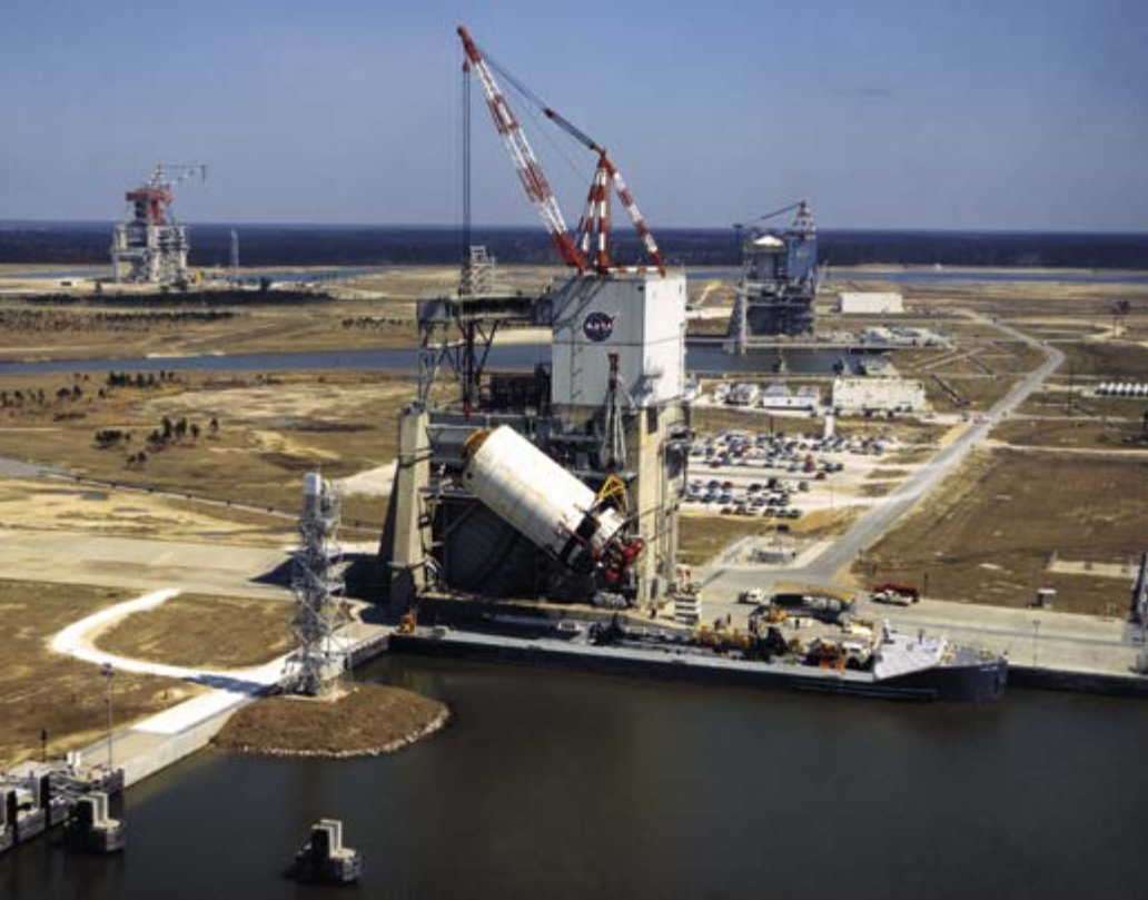
Příprava druhého stupně Saturnu V S-II před zkouškami v Mississippi Test Facility (dnes Stennisovo středisko NASA).
