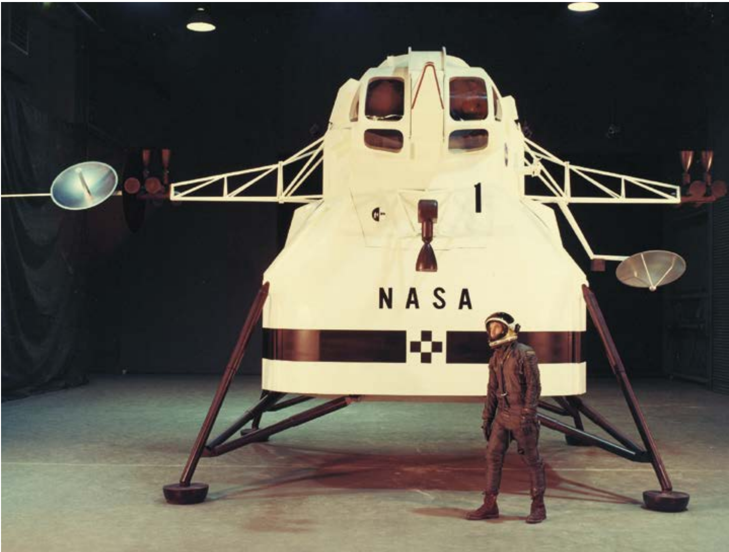
Rozmerová maketa lunárneho modulu podľa návrhu spoločnosti General Dynamics.
