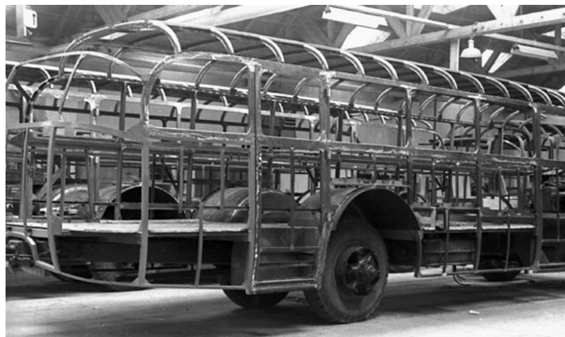
Pohled do výrobního závodu Karosa ve Vysokém Mýtě s autobusy RO v různém stupni rozpracování
