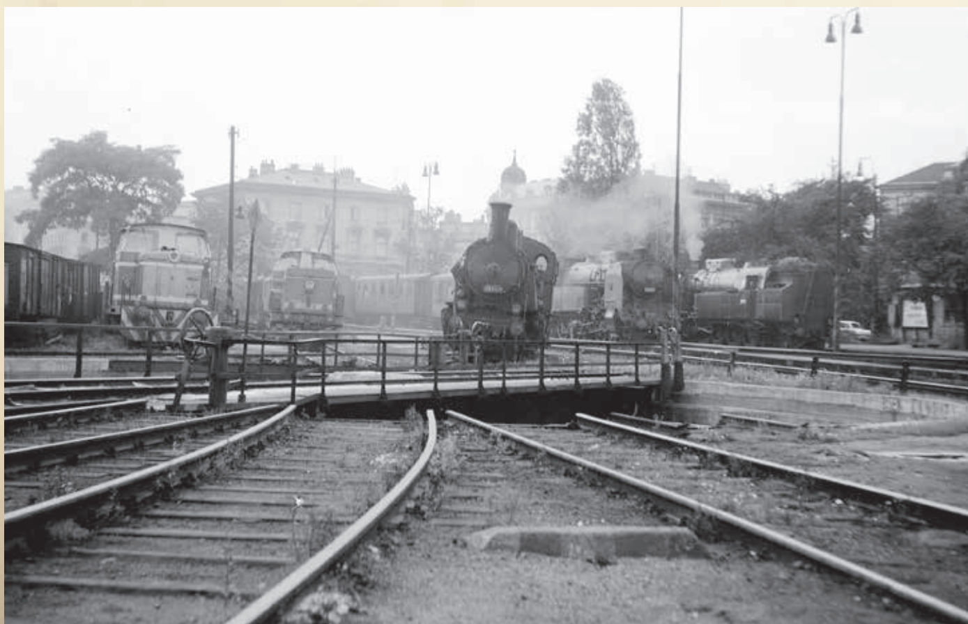
Praha Těšnov, pohled od výtopyny k výpravní budově přes točnu a zde typické stroje T 334.0, T 444.02, 434.1139 a 464.0, zachycené dne 5. 9. 1970, foto Petr Ovsenák.
