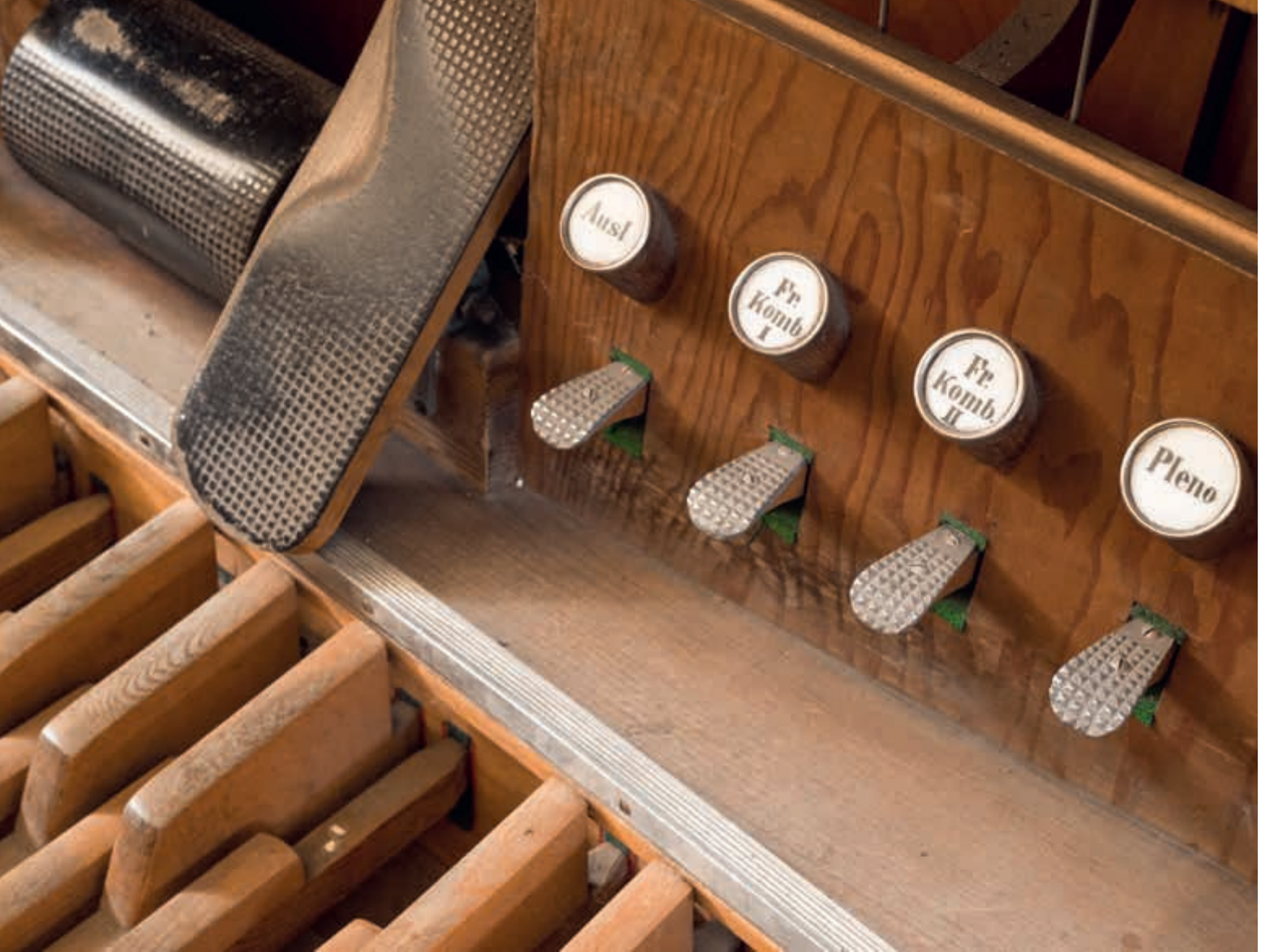
Rejstříkové crescendo jako válec a ovládání žaluzií pomocí balanční šlapky
