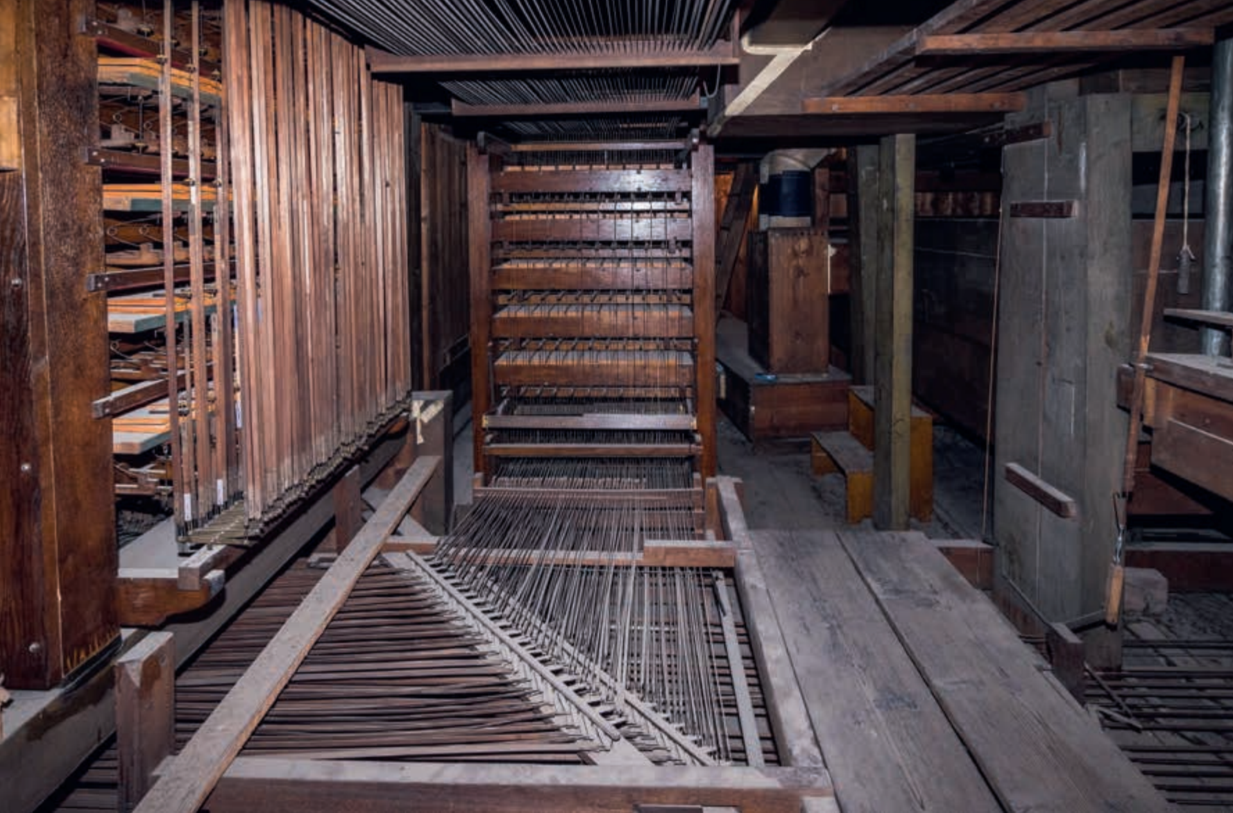
Traktura varhan s Barkerovým aparátem (pákou)
