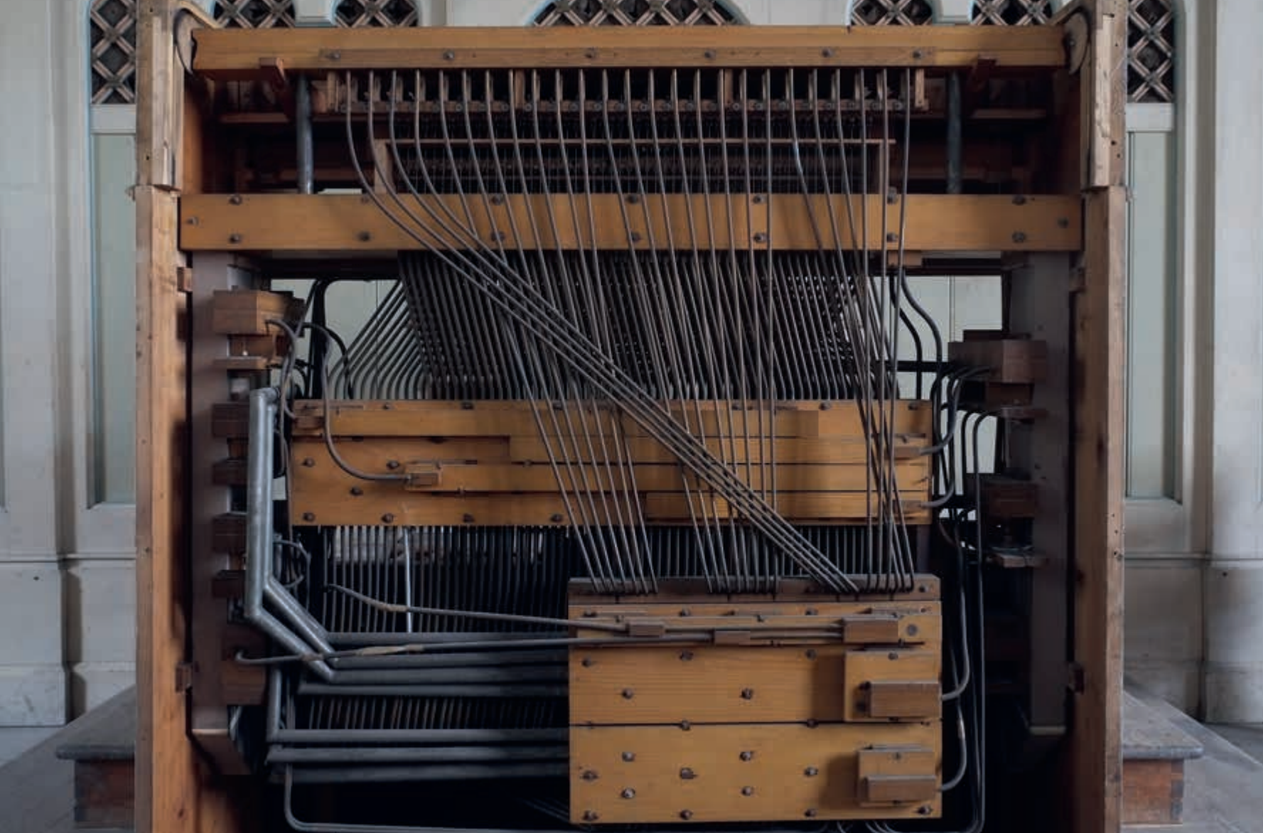
Pneumatická traktura hracího stolu – řešení varhanáře Karla Neussera
