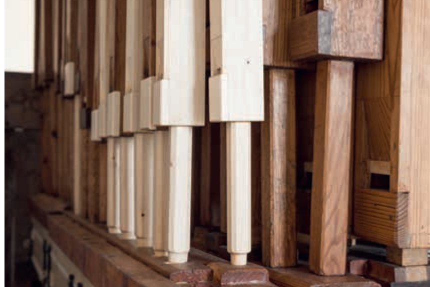
Dřevěné pedálové píšťaly stojící na pedálové vzdušnici
