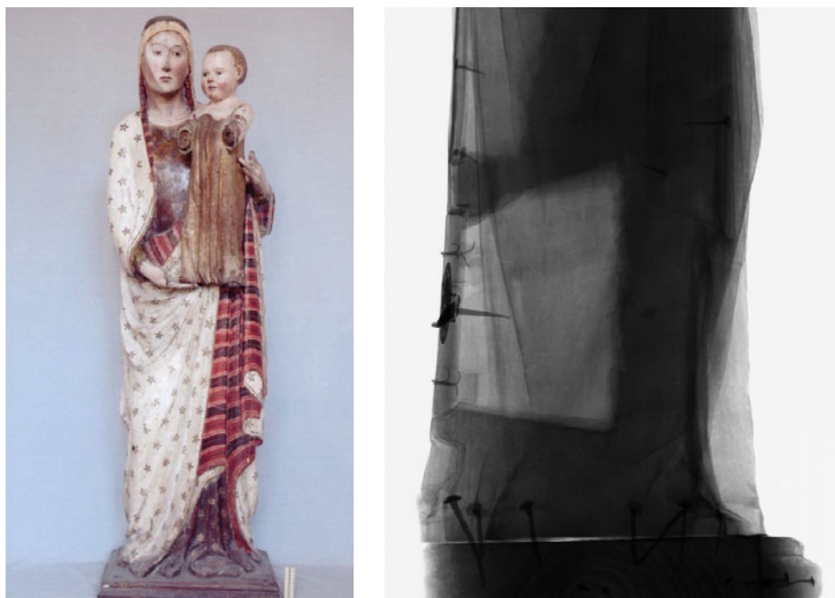
Obr. 6: Ukázka polychromované dřevěné sochy Madony s Ježíškem z druhé poloviny 14. století z Fabriana v Itálii (vlevo) a tomografický snímek spodní části sochy Madony se zabudovaným relikviářem se zámek (vpravo). V tomogramu jsou také velmi dobře patrné spojovací hřeby. [Kapitany et al, 2016]
