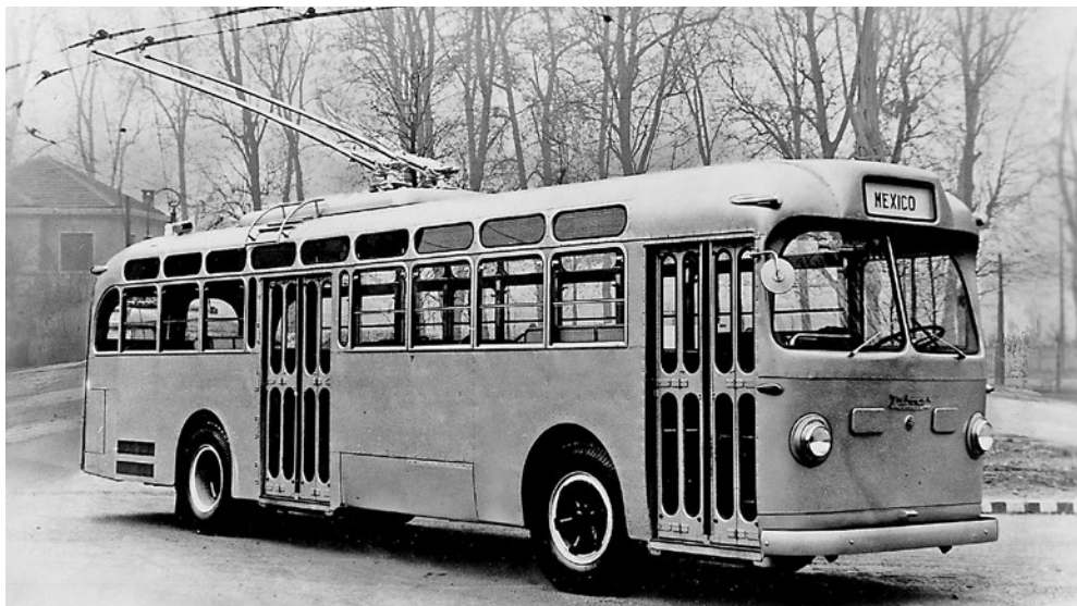
❖ Italský trolejbus Alfa-Romeo Tubocar s elektrickou výzbrojí Marelli z roku 1952, určený pro Ciudad de México
