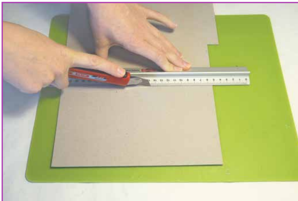
Obr. 3.1 Lepenku řežeme vždy ulamovacím nožem podle kovového pravítka
