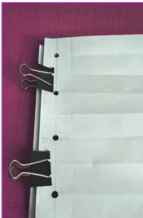
Obr. 4.4 Využití pomocného papíru a binder klipů pro proděravění knižního bloku
