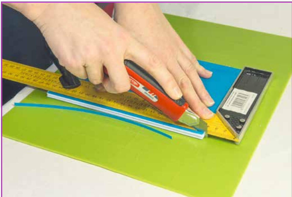
Obr. 3.10 Řez vedeme nožem podél připevněného pravítka
