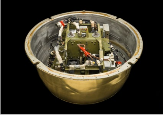
Schéma prvního Discovereru, zatím ještě bez kamery. Aparatura tvořila integrální součást stupně Agena, oddělovalo se pouze návratové pouzdro. (Zdroj: wikipedia.org)
