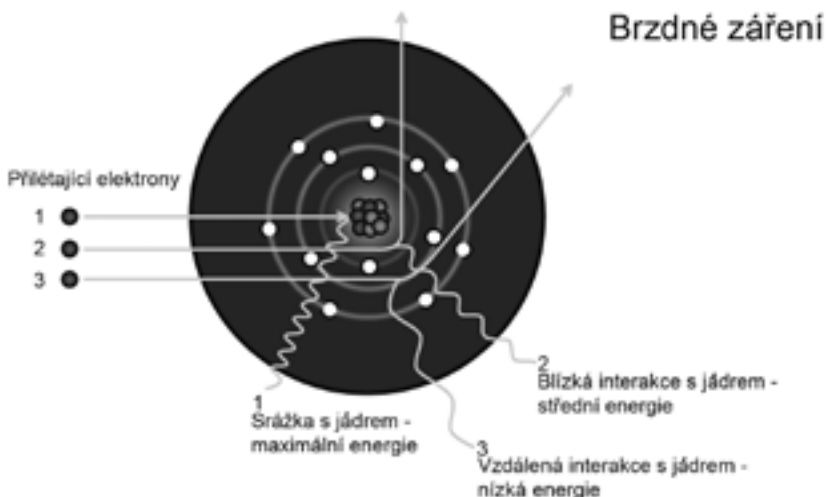
Obr. 2: Schematické znázornění vzniku brzdného záření
