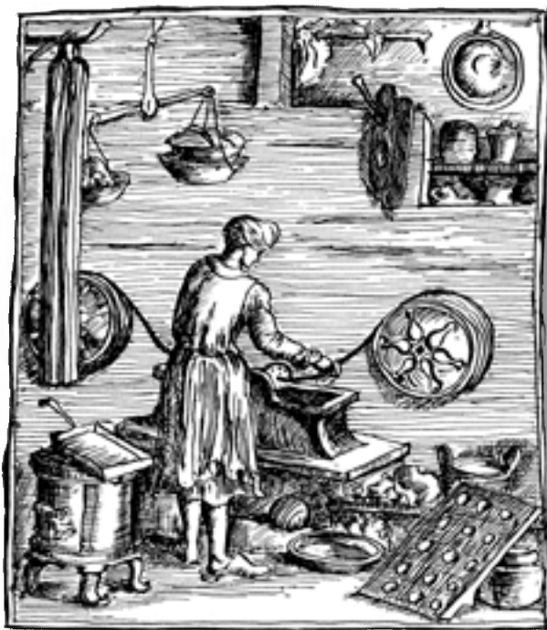
■ Obrázek 2 Voskař při výrobě svíček tažením, podle reprodukce rytiny z knihy Ch. Weigela Abbildungen der Gemein-Nützlichen Hauptstände, Regensburg 1698
