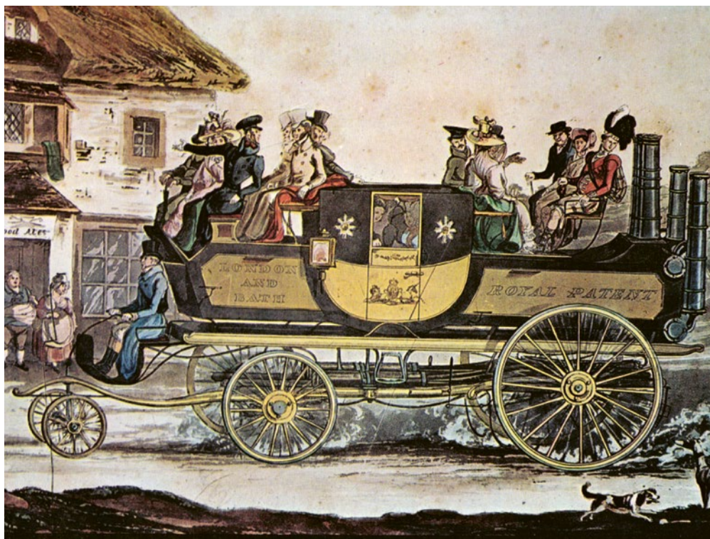
Parní dostavník Goldworthyho Gurneje z roku 1827 pojal 21 cestujících a jezdil mezi Londýnem a lázeňským městem Bath
