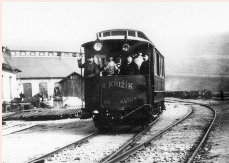
Pokusný akumulátorový vůz, který jezdil na trati z Prahy do Měchenic
