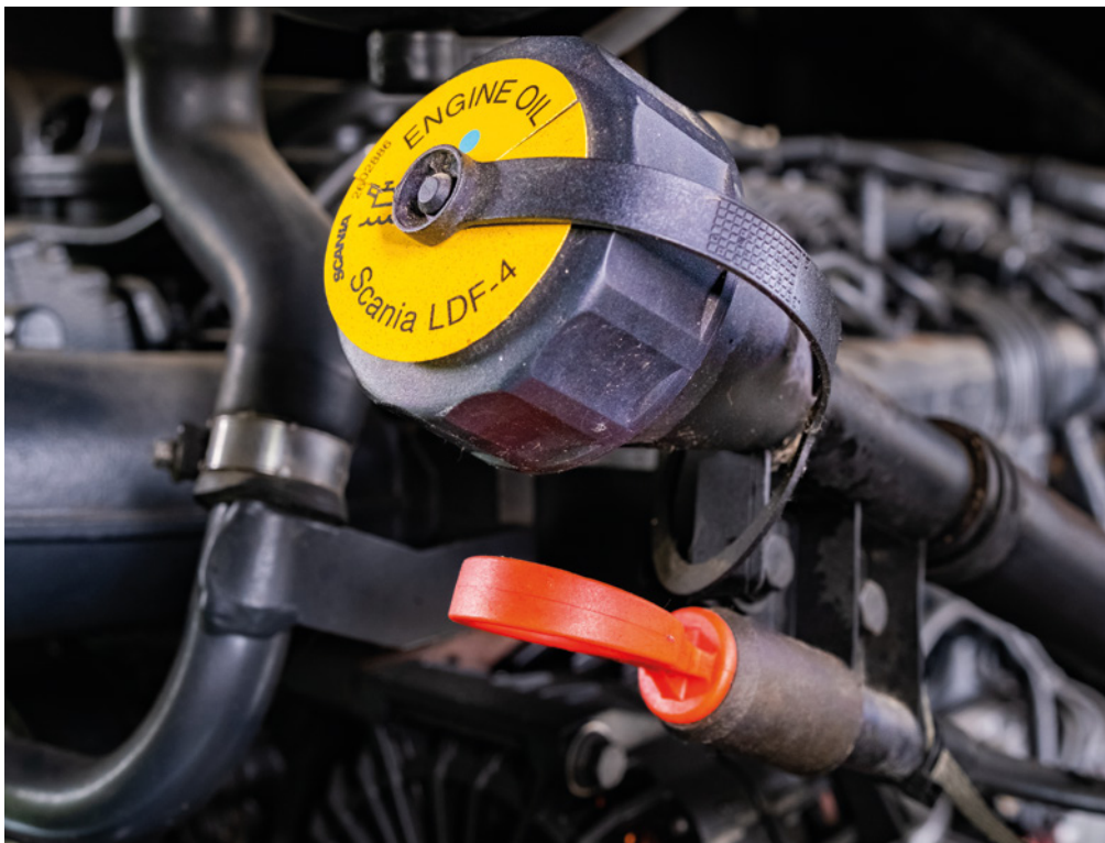
Červeně označena měrka oleje. Žlutě označeno místo pro dolítí oleje.
