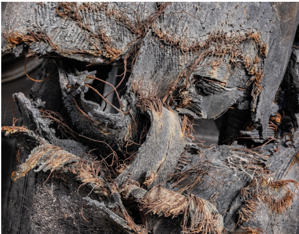
Bočnice pneumatiky byla odřena, pravděpodobně od obrubníků. Jízdou a zahřátím došlo ke zvýšení tlaku v pneumatice a jejímu defektu.
