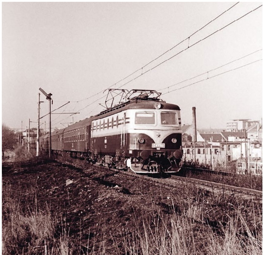
Zavazování trakčního motoru lokomotivy E 499.0 s lamelovou spojkou Sécheron, archiv ŠKODA
