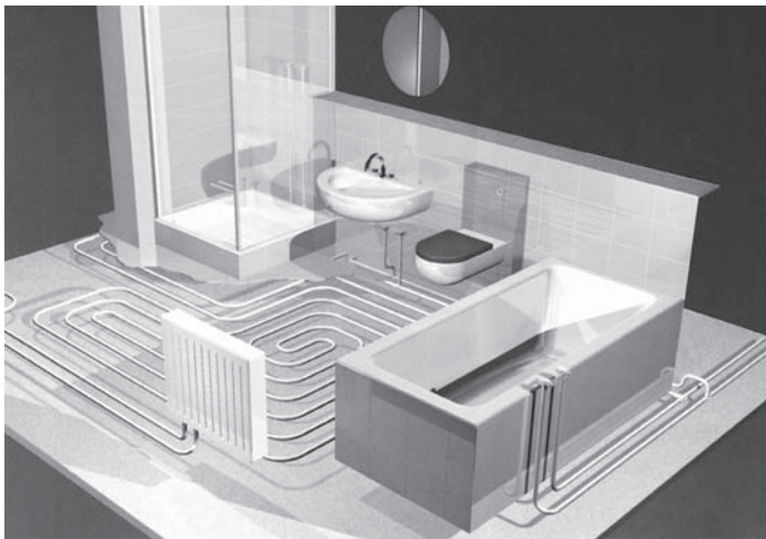
Potrubí pro vytápění a rozvod teplé vody v koupelně
