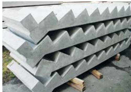
Obr. 1.16 Prefabrikované železobetonové prvky dvouramenného schodiště
