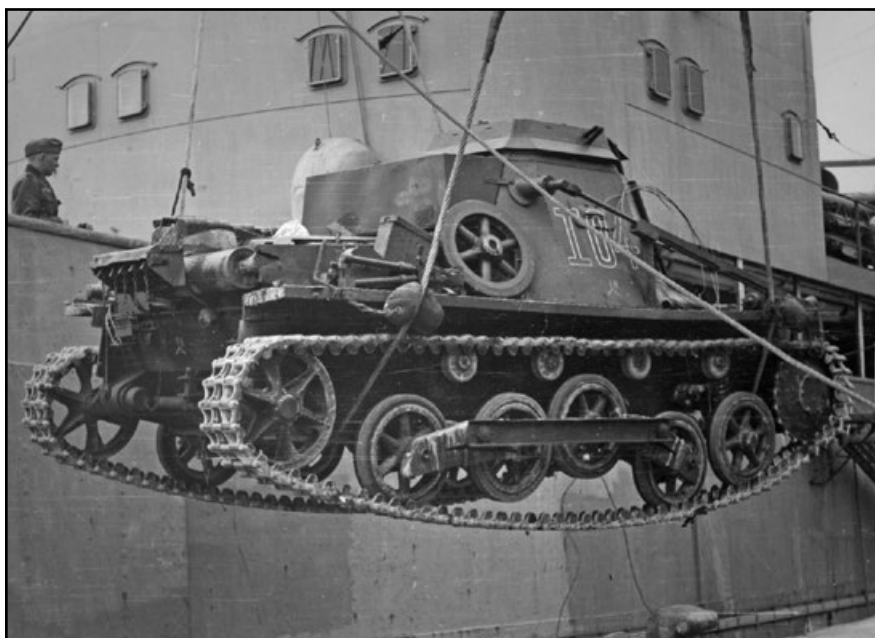
▲ Leichter Panzerbefehlswagen upravený pro nasazení v tropech byl k dispozici od počátku roku 1941. Stroj na snímku je právě vykládán z lodi v libyjském Tripolisu v únoru téhož roku. Tropická verze zahrnovala upravenou ventilaci motorového prostoru a větší chladič. Na zadní části nástavby je upevněn úložný box a na zadní straně tlumiče výfuku je vrhač dýmotvorných granátů NAKV. Ze strany velitelské věžičky vyčnívá zářezka příklopu. National Archives and Records Administration
