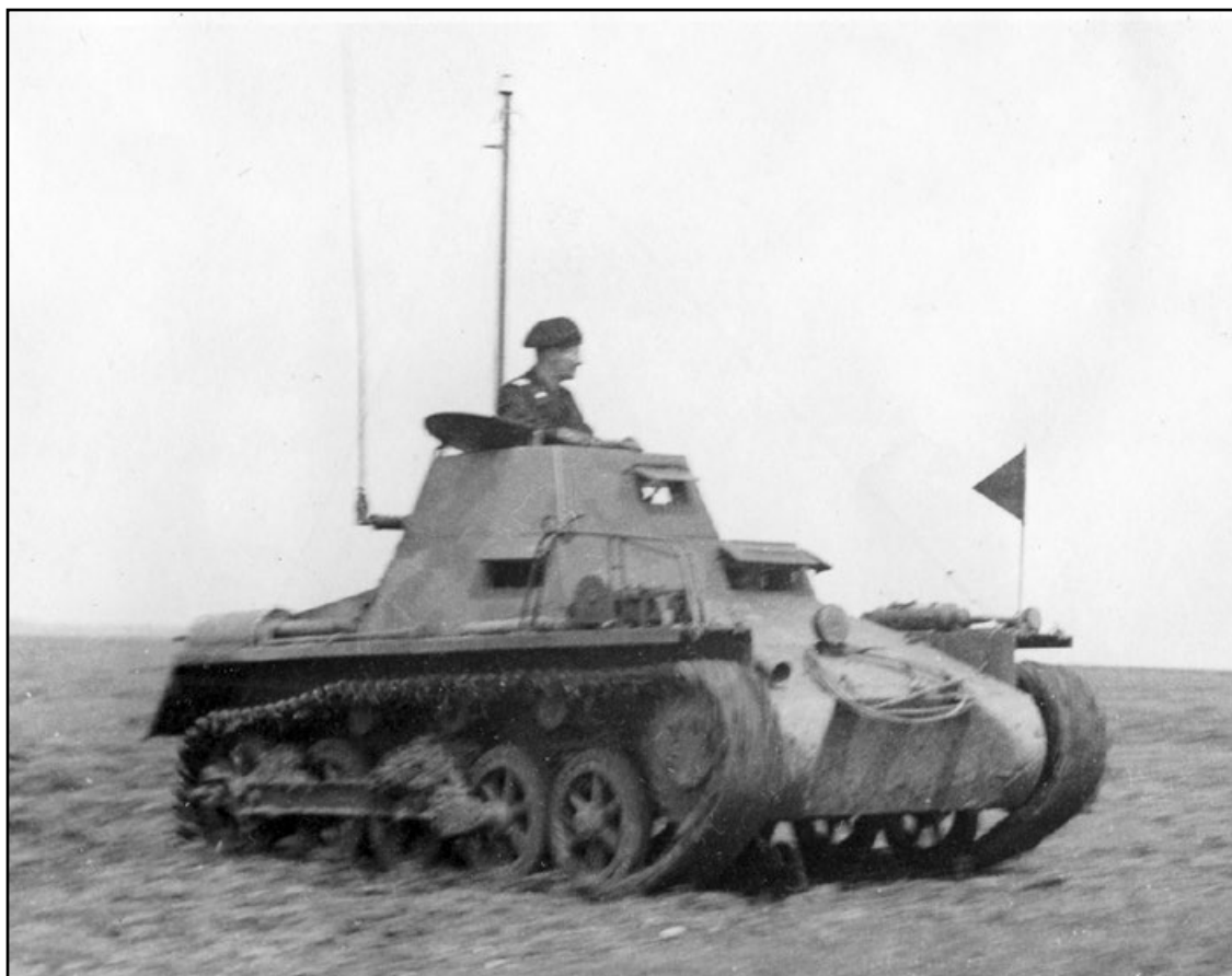
▲ Leicht (Funk) Panzerwagen, na podvozku Panzerkampfwagen I Ausf A, byl prvním obrněným pásovým velitelským vozidlem, které bylo zavedeno do výzbroje Wehrmachtu. Mělo pancéřovou nástavbu od firmy Daimler-Benz, která byla umístěna k horní části korby. Vešla se sem pouze jedna radiostanice FuG 2, takže využitelnost byla omezená. Patton Museum
