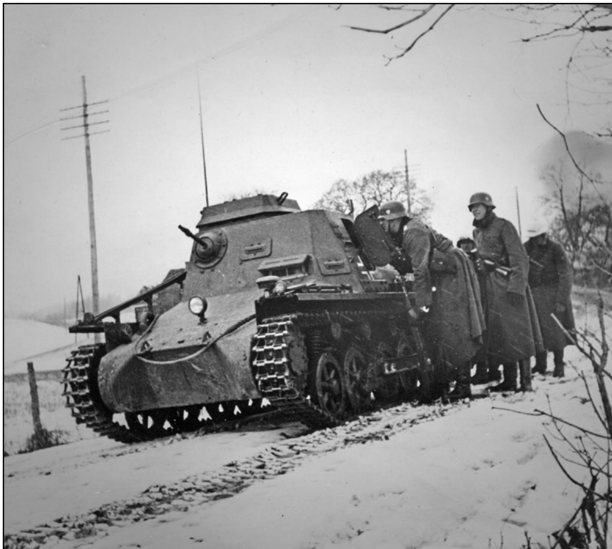
▲ Leichtes Panzerbefehlswagen (SdKfz 265) bylo rádiem vybavené obrněné velitelské vozidlo na podvozku Panzerkampfwagen I. V pancéřové nástavbě vyrobené společností Daimler-Benz a umístěné na horní části korby byla obousměrná radiostanice – vysílač-přijímač FuG 6 a přijímač FuG 2 – a rovněž tabulka s mapovými podklady. Kulová lafeta kulometu MG 34 byla v pravé přední části nástavby. Vozidlo na snímku mělo velitelskou věžičku na pravé straně střechy nástavby, což byl doplněk pocházející z roku 1938. Voják nahlíží do levých bočních dveří vozu kleiner Panzerbefehlswagen. National Archives and Records Administration
