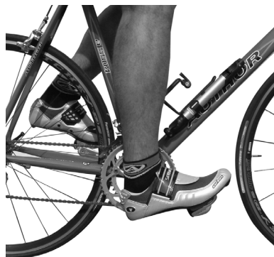
Obr. 8 Nesprávné postavení chodidla – pata „propadá“ pod osu pedálu
