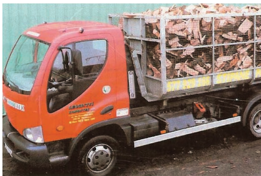
Obr. 14 Auto upravené pro přepravu palivového dříví
