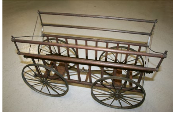
Obr. 2 Model vozu koněspřežky, který Josef Božek postavil na přání profesora Gerstnera, aby se ověřilo chování pojezdů v obloucích. Model z roku 1828 má mosazná kola s okolky (Foto NTM)
