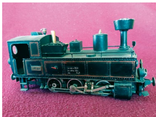
Obr. 21 Model lokomotivy řady 310.0 v měřítku 1 : 45 od Ing. Elmara Kloze z leptaného zinkového plechu
