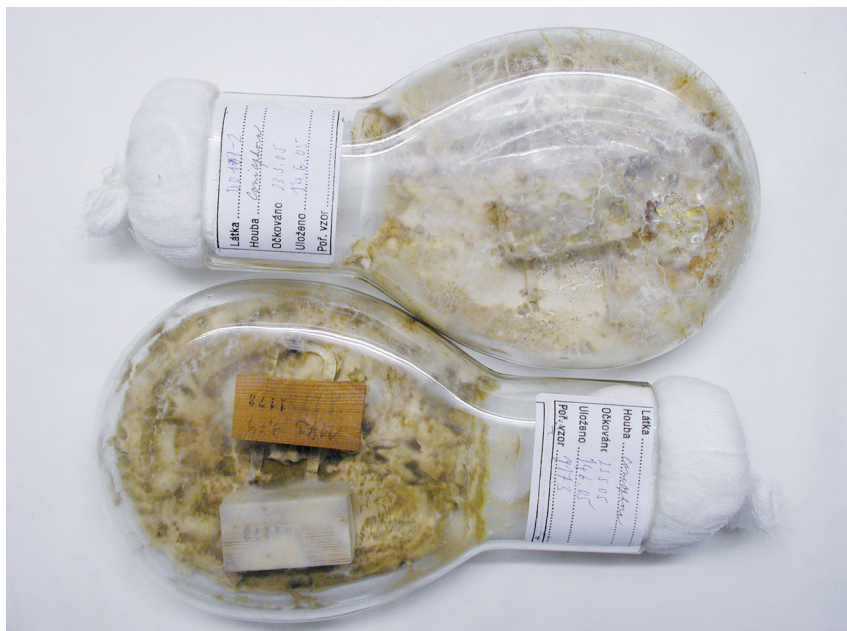
Obr. 2 Zkouška podle ČSN EN 113 preventivní účinnosti proti dřevokazným houbám Basidiomycetes
