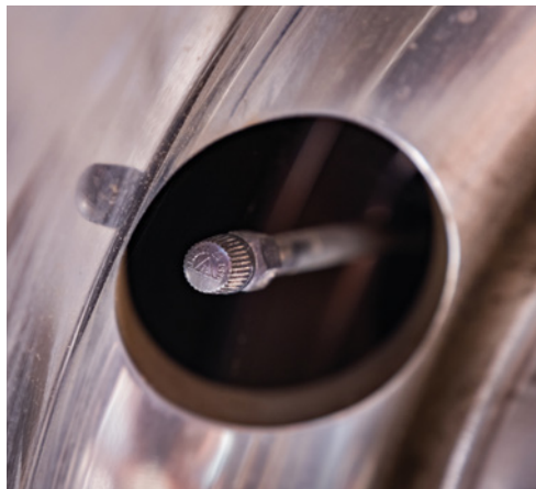
Ventilek vnitřní pneumatiky u dvojmontáže je lehce přístupný.
