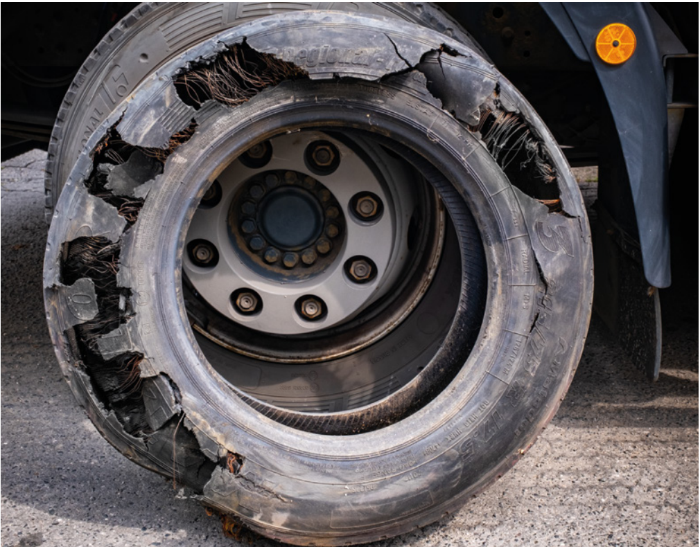
Bočnice pneumatiky byla odřená, pravděpodobně od obrubníků. Jízdou a zahřátím došlo ke zvýšení tlaku v pneumatice a jejímu defektu.
