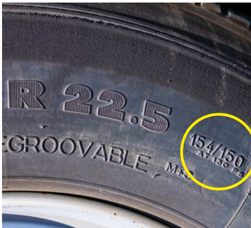
Maximální tlak, na který je pneumatika konstruována, je uveden na pneumatice.
