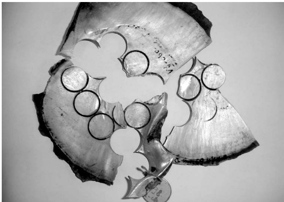
Znázornění postupu výroby perleťových knoflíků ze suroviny – součást expozice Českého průmyslového muzea. Dnes inv. č. H4-59471a.
