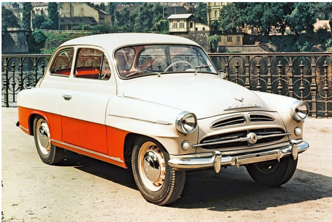
Škoda 445 Spartak vybavená motorem 1221 cm 3 o výkonu 45 k
