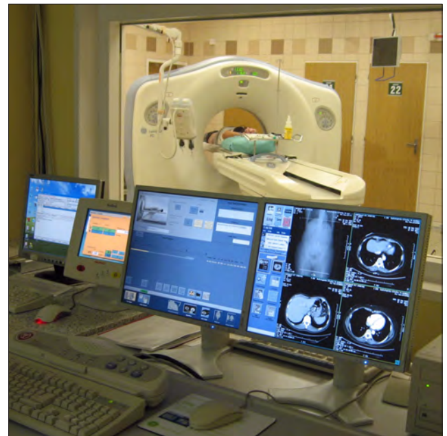
Obr. 2.14 Hlavní součásti CT přístroje – pohled z ovladovny do vyšetřovny. Pacient ležící na výsuvné desce vyšetřovacího stolu se postupně posouvá do otvoru v gantry. Uvnitř gantry je uložena rentgenka a systém detektorů, které rotují kolem pacienta. Před gantry na levé straně je patrná tlaková stříkačka pro podávání kontrastní látky. V ovladovně jsou monitory, na nichž se sleduje průběh vyšetření a jsou zobrazovány získané skeny.
