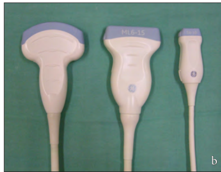
Obr. 2.7 (a) Ultrazvukový přístroj. (b) Sondy – různé typy. Vlevo konvexní sonda s nižšími frekvencemi pro vyšetřování hlubších struktur, např. břicha. Uprostřed lineární sonda s vyššími frekvencemi pro vyšetřování povrchněji uložených struktur, např. krku, cév končetin (obraz na přístroji byl zhotoven touto sondou). Vlevo sektorová sonda s malou kontaktní plochou určená zejména pro vyšetřování nejmenších dětí.
