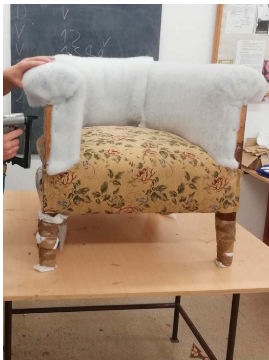
9 Čalounění opěradla spojeného s područkami, přibíjení průmyslových spojovačů (sponek) pneumatickou sponkovací pistolí místo ručního přibíjení hřebíků čalounickým kladívkem
