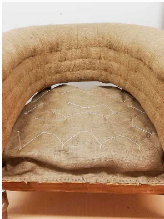
3 Překrytí pružin hustou jutou (pérovým plátnem) a přišití juty k závěrným závitům pružin
