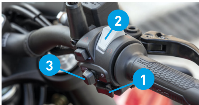
1 - startér / 2 - nouzové zhasinání motoru / 3 - vypínač světel
