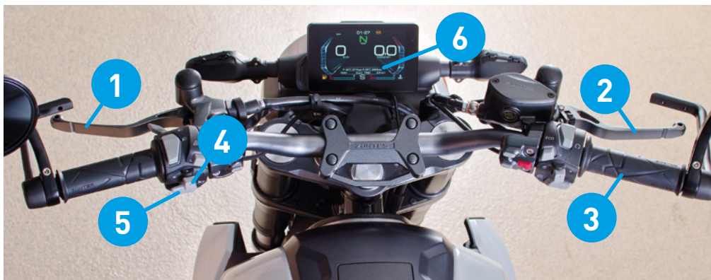
1 - spojka / 2 - brzda / 3 - plyn / 4 - směrovky / 5 - klakson / 6 - přístroje
