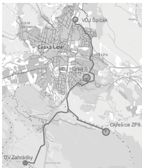
Obr. 2.1 Příklad situace jednoduché potrubní sítě
