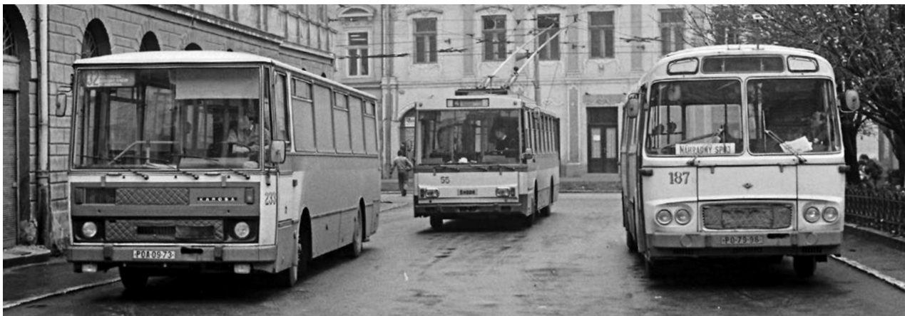
▲ Nástup nové řady: vlevo Karosa B 731, vpravo její předchůdce Karosa SM 11. Snímek doplňuje trolejbus Škoda 14Tr, který se vyráběl současně s výrobní řadou Karosa 700. Záběr pochází z Prešova z druhé poloviny osmdesátých let
