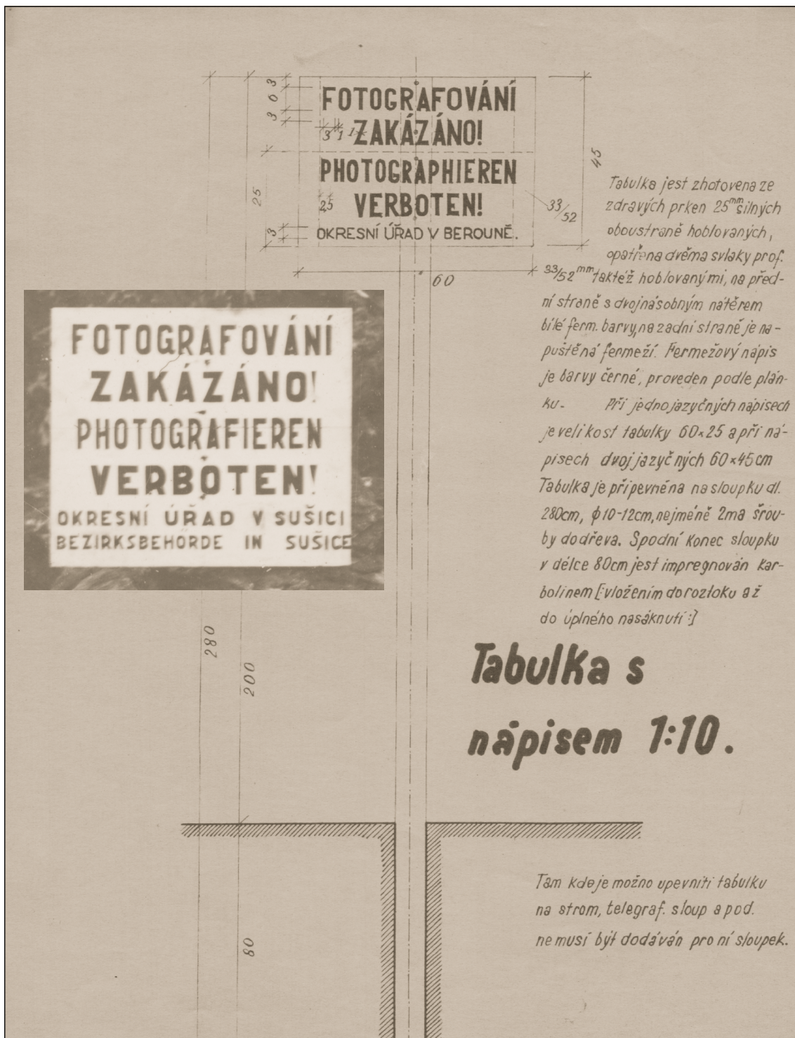
Výkres typového řešení tabulky se zákazem fotografování, která byla osazována v úsecích I. sboru. Na vložené fotografii je zachycena podoba tabulky vyrobené pro úsek H-40 Sušice truhlářem Karlem Petrem ze Zadova.
