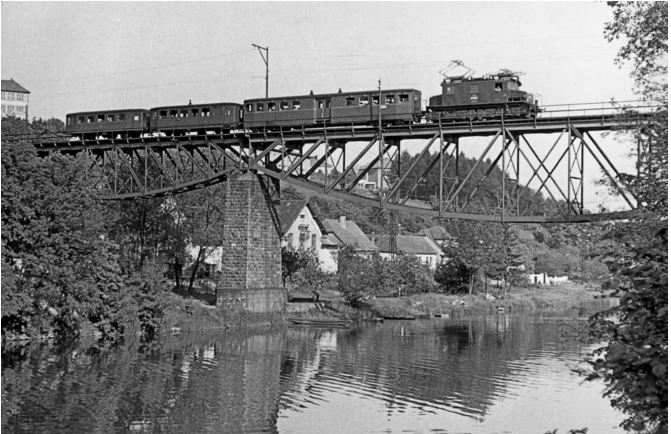
Doprava na bechyňské lokálce se na počátku šedesátých let nesla ve znamení z Prahy předaných elektrických lokomotiv E 436.0. Dorazily sem postupně stroje provozních čísel 01, 02 a 04. Původní nákladní lokomotivy na zdejší sklonově náročné trati dopravovaly nákladní, smíšené, ale také čistě osobní vlaky, tak jako v tomto případě, kdy veze vlak složený z vozu Calm a dvou přípojných Blm za motorové vozy a překonává most v Táboře. Foto Václav Bareš. Sbíрка Jaroslav Wagner
