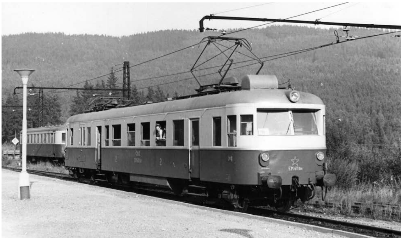
V koncové stanici Lipno byl 28. srpna 1970 zachycen elektrický motorový vůz EM 411.001. Ten vznikl rekonstrukcí původního motorového vozu M 150.005, což byl původem německý kořistní motorový vůz VT 137.147 DRG z roku 1936. Již v roce 1948 byl administrativně zrušen a teprve v roce 1954 byl, s ještě jedním odlišným vozem, v plzeňské Škodovce přestavěn na elektrický vůz. Zrušen byl až v prosinci 1973. Foto Václav Bareš. Sbíрка Jaroslav Wagner
