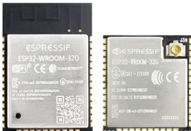
Srovnání modulů s anténou MIFA (vlevo) a s konektorem U.FL (vpravo)
