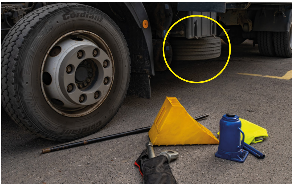
Umístění rezervní pneumatiky na levé straně vozidla.
